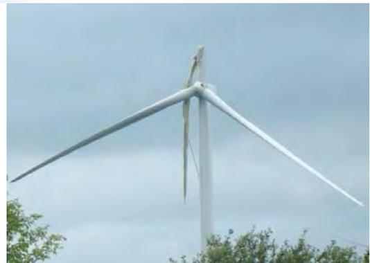
激しい暴風雨によって破損したブレード
